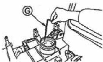
После каждой операции снимите крышку, достаньте топливный щуп G и проверяйте уровень топлива.
