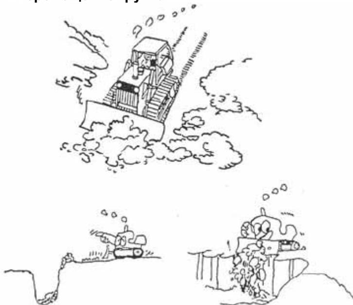
В нормальном случае бульдозер рассчитан на качественное перемещение песка или земли не более чем на 70 метров. В том случае если данная дистанция превышает 70 метров, следует использовать скребок. При перемещении грунта по наклонной поверхности самой производительной является работа по направлению сверху вниз.
