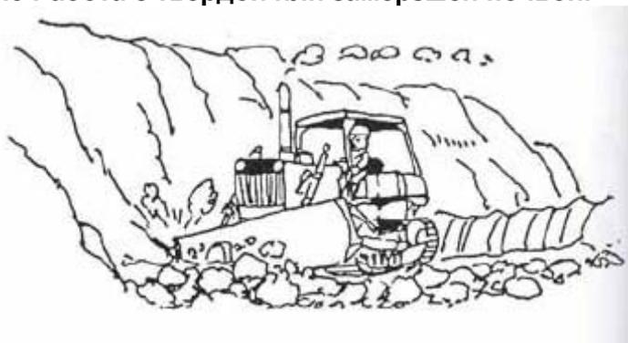
1. При работе с твердой или замерзшей почвой следует использовать отвал.
